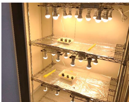
図1 簡易人工気象室
