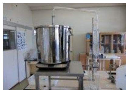
図5 水蒸気蒸留の様子
